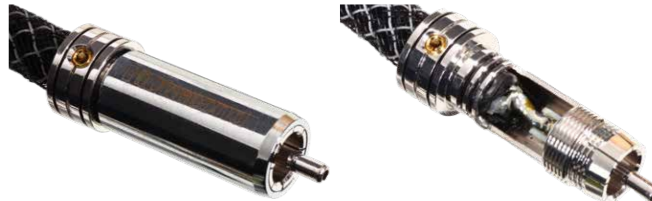
I connettori sono placcati in Rodio e accettano cavi fino a 10 mm di diametro. Lo scavo laterale è realizzato per facilitare la saldatura di massa.
