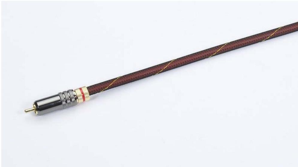
Il cavo digitale coassiale "Diamond DGT - MkII" di circa sei millimetri di spessore e abbastanza flessibile ha naturalmente un'impedenza caratteristica di 75 ohm e spine di alta qualità. I conduttori in rame speciale 2VRC a bassa capacità (55pF/m) dovrebbero garantire il miglior flusso del segnale. Prezzo: 120€.
