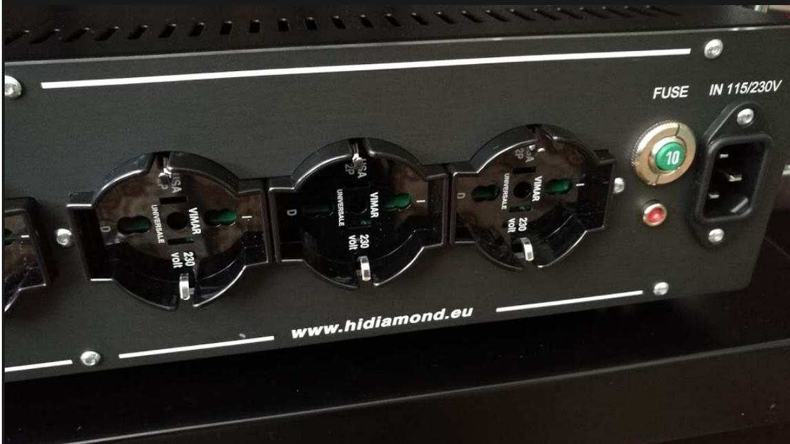
HiDiamond HDX3 è alimentato da sette prese ad incasso con contatti di rame puliti placcati in oro di alta qualità sul retro. L'intero sistema è protetto da sovracorrente con un fusibile automatico da 10A. La potenza totale disponibile è superiore a 1000 watt. Il dispositivo ha un'altra linea di protezione principale, che protegge l'elettronica connessa da fulmini e sovraccarichi. Vale la pena notare qui che nessun apparecchio elettrico diverso da quello audio deve essere collegato
